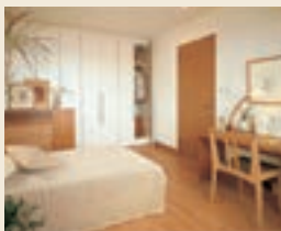
クローゼットを動かすことで間取りを変更できる(可動間仕切収納/積水ハウスオリジナル)。子どもたちが幼い間は広々としたワールームと一緒に、独立心が芽生え始めたら、セミオープンな子ども室に変更。プライバシーが必要になる時期には、独立した個室に変更することができます。
