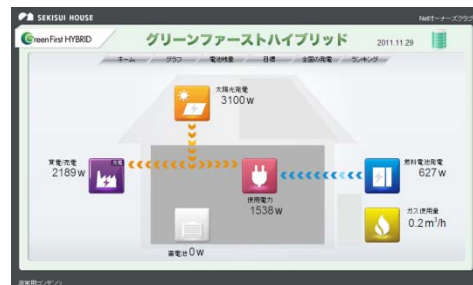
当社が独自開発したHEMS画面(平常時・日中) 3電池の状況が一目で分かり、連動制御も行う
