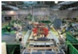
独自の構造躯体の基幹部材である軸組の製造工程では、工場内で成形されたC型鋼を切断、孔あけ後、一邸ごとに組み立てます。
