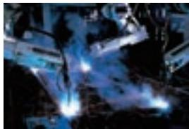
一邸ごとに異なる多種多様な軸組は、次工程での生産順序も考慮し、ロボットを駆使して1枚ずつ組み立てます。溶接検査は熟練の社員の眼で確実にを行い、品質管理を徹底しています。
