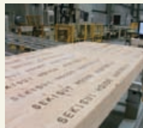
「カムデンヒルズ」に近接した場所に工場を設置し、プレカットを行います
