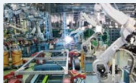
多品種の軸組を「完全邸名別生産」できる自動化ラインは住宅業界初
