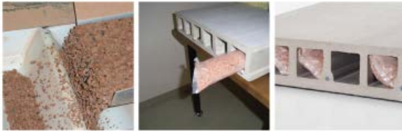
瓦の端材を破砕し、振動を吸収する充填材として使用
