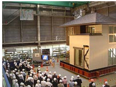
SHEQAS 実大振動台実験
