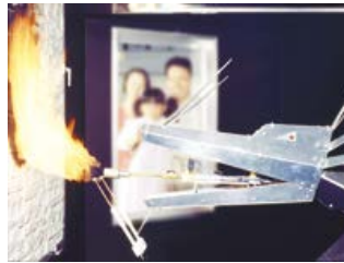
ドラゴンが外壁に炎を噴く仕掛けで、防火性能をチェック
