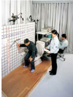
トイレの手すりの使い勝手を検証
