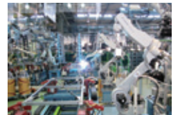
多品種の軸組を「完全邸別生産」できる自動化ライン(静岡工場)
