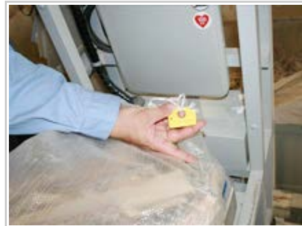
図6 重量計測と同時にICタグを読み込む
