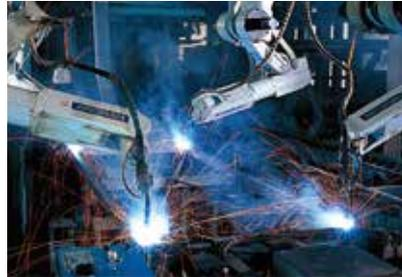
熟練の作業者に匹敵するセンシングカメラを搭載した溶接ロボット
