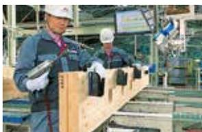
構適用金物を正確に取り付けた状態で出荷することで、施工現場での作業を軽減
