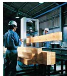
シャードウッド構造材の梁の曲げ強度試験。徹底した生産品質管理を実施
