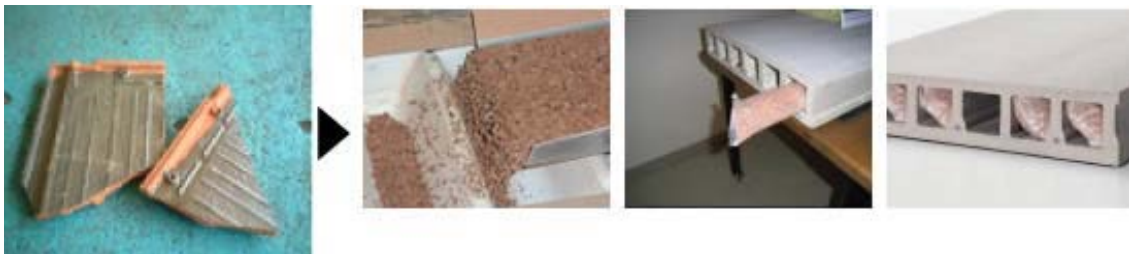
瓦の端材を床の衝撃音緩衝材として使用
