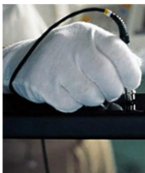
鉄骨の防錆塗装厚検査。
