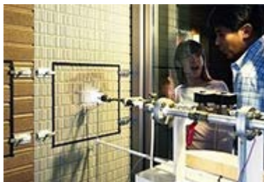
実際に外壁に炎を当てる実験で耐火性を確認（関西 住まいの夢工場「シャールウッドラボ」）
