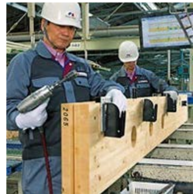
構造用金物は手作業で丁寧にプレセット
