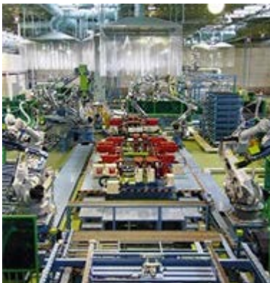
ロボットによる自動化ラインを備え、「完全邸別生産」を実現
