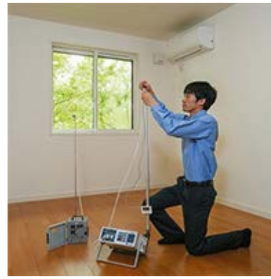
実大建物において、空間の化学物質濃度や経時変化を測定・評価
