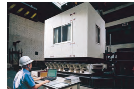
構造実験場での耐震性を検証する実大振動台実験
