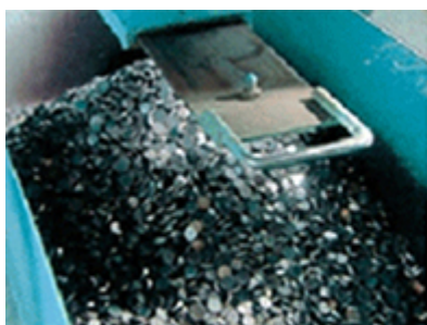
ボルト穴開けで発生したパンチくず
