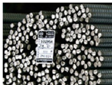
リサイクルされた鉄筋
