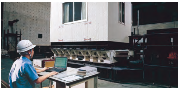
構造実験場での耐震性を検証する実大振動台実験
