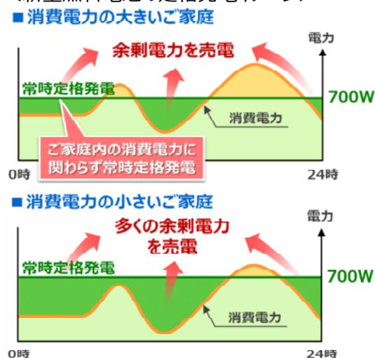
集合住宅では一住戸あたりの屋根面積が小さいため、太陽光発電システムの導入による大幅なCO<sub>2</sub>排出量の削減が困難でした。燃料電池は分散型電源であり排熱の有効利用が可能ですが、設置スペースの問題や、居住者のライフスタイルによって発電量が左右されるという課題がありました。当該マンションでは、小型化等を実現した新型燃料電池を導入することで、設置スペースの問題を解決。また、24時間700Wの定格出力運転を行うことで最大限高効率に発電した環境負荷の小さい電力をご家庭で消費したり、大阪ガスに売電することができます。これにより、多様な居住者にメリットが期待されます。本取り組みは超高層マンションで実現するCO<sub>2</sub>排出量の削減手法として先進的であり、国土交通省『平成27年度 第2回サステナブル建築物等先導事業(省CO<sub>2</sub>先導型)』として採択されています。
