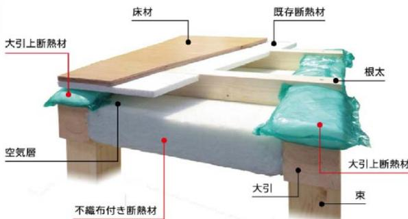
床を解体せず、床下から断熱材を設置できる独自の工法で、足元の冷えや暖まりにくさを解消します。1日施工で住まいながらの工事が可能です。
