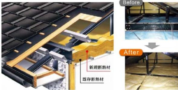
既存断熱材の上に新たな断熱材を敷き並べ、断熱性能を引き上げます。冬季は暖房による熱が天井から逃げにくく、夏季は屋根裏の熱が室内に伝わりにくくなります。
