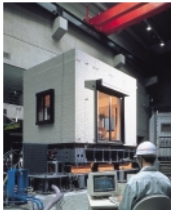
地震の振動を再現し、外壁の強度を検証
