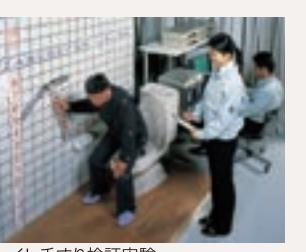
トイレ手すり検証実験(積水ハウス総合住宅研究所)
