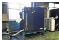
鉄工場コンプレッサー(高効率機器 木工集塵機(高効率機器への変更)への更新)
